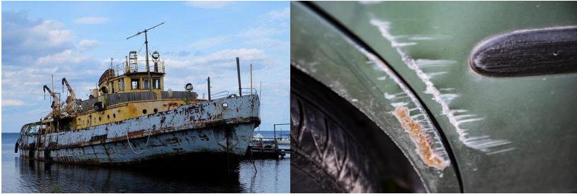
Figura 5: Navio e carro sofrendo corrosão. Fonte:Pixabay
