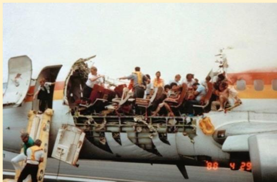
Figura 2: O que sobrou do Boeing 737-297 após acidente devido à corrosão.
