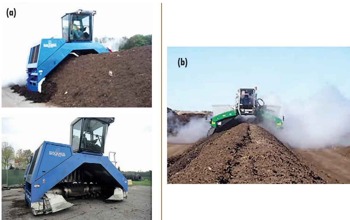
**Figura 14** - Método natural de aeração que utiliza reviramento mecânico das leiras.
