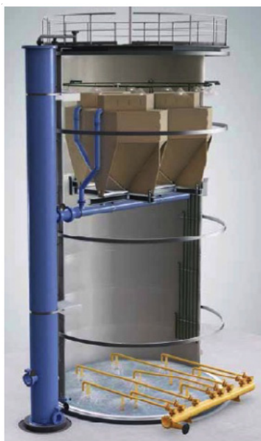
Figura 19: Desenho esquemático de um reator UASB.
