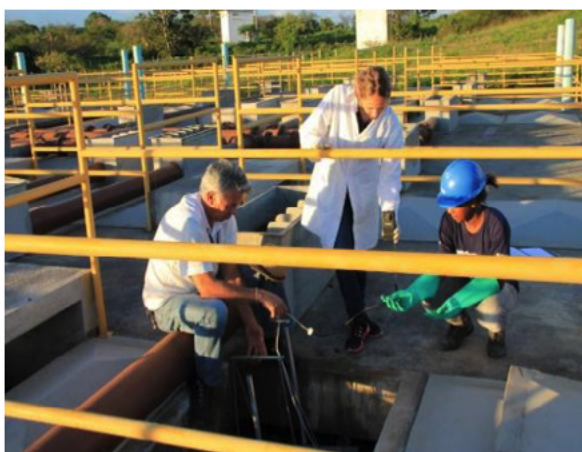
Figura 4: UASB da ETE Feira de Santana, medição de biogás ETE para tratamento de esgoto de 100.000 hab., projeto P&D, potencial de aproveitamento de biogás.
