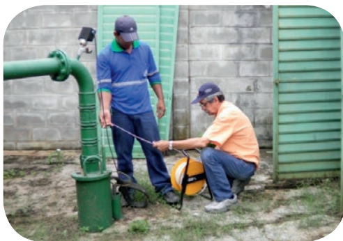
Medição de nível d'água dentro do poço (à esquerda) e coleta de água para análises físico-químicas (à direita)
