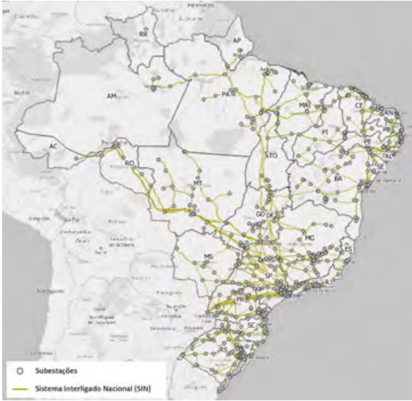
FIGURA 6 Linhas de transmissão e subestações do SIN.
