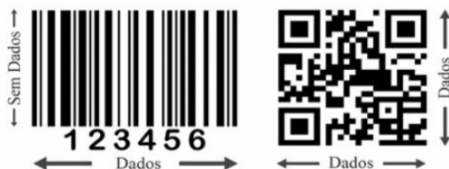
Figura 1 – 1D: Ilustração do Código de Barras; Figura 2 – 2D: Ilustração do QR Code
