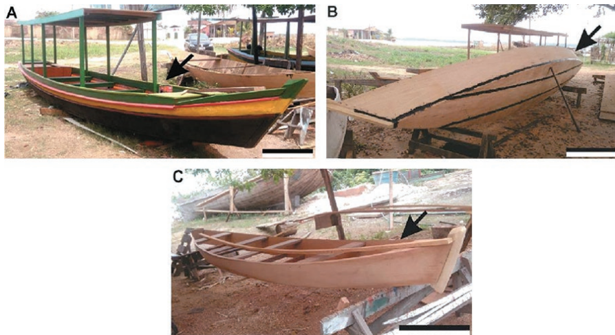
Figura 2 – Embarcações produzidas na cidade de Marabá: A) reboques; B) montarias; C) botes. Barras de escala: 70 cm, 50 cm e 60 cm, respectivamente
