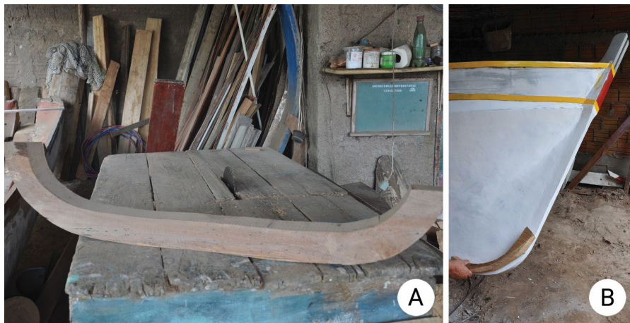
Figura 9 – Madeiras de formato curvo utilizadas para confecção de peças da canoa: A) caverna; B) roda de proa
