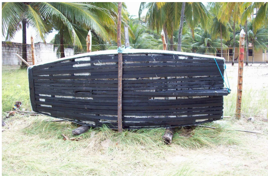
Figura 7 – Casco de jangada de tábua preenchido com isopor
