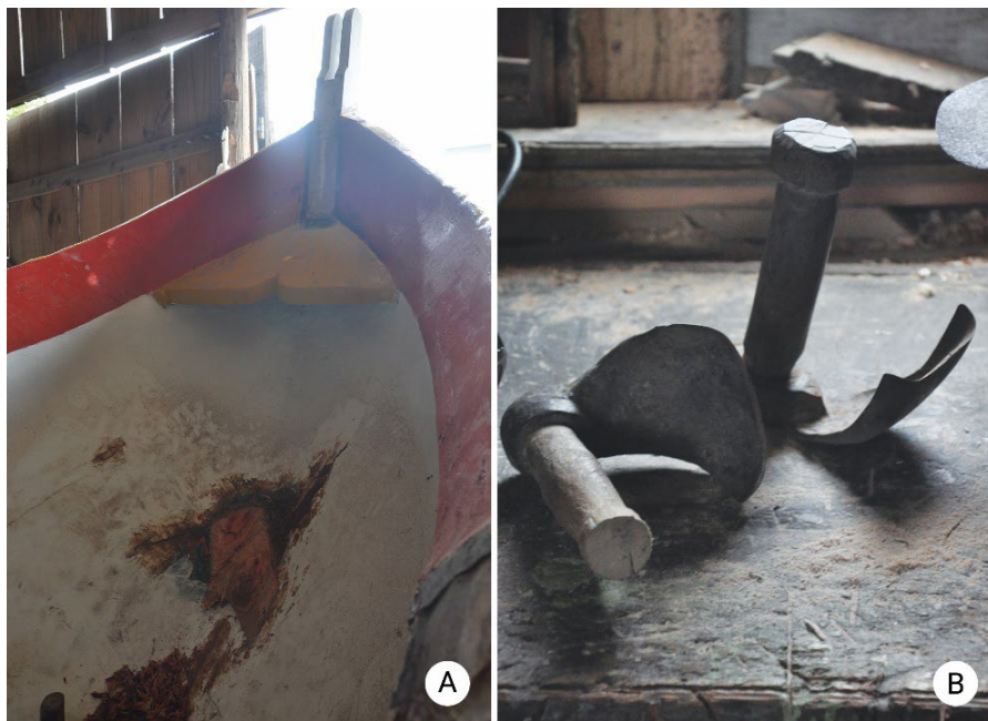
Figura 12 – Remendo em parte curva da canoa (A) e enxó goiva (B)
